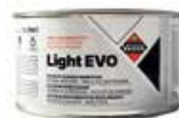
Stucco cremoso ultraleggero per medio/alto spessore applicazione a spatola. Si puo' utilizzare su superfici danneggiate fino a 6 mm di profondita'. Semplice da applicare e facilissimo da carteggiare, garantisce una finitura omogenea senza cali. Ottima adesione su superfici di acciaio, acciaio zincato, alluminio, SMC, fibra di vetro e materiali compositi.
