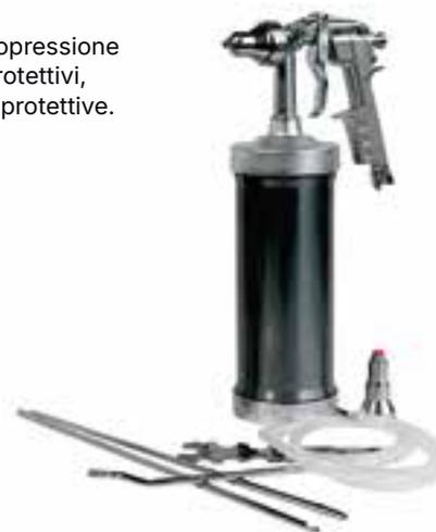
Pressione di esercizio: da 3 a 6 BAR. Viene fornita con due prolunghe in nylon, cannula rigida in metallo con getto a 360° e ugelli vari. Su richiesta cannule per pistola L11 U/90
